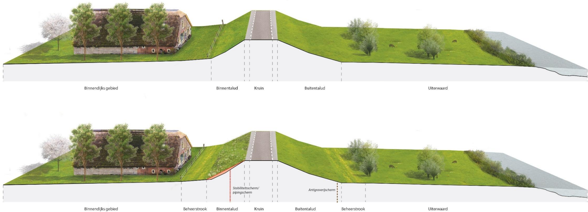
Figuur 7-2: Indicatief principeprofiel van kansrijk alternatief “Vertrouwde dijk”. Het bovenste profiel geeft een indicatief beeld van de huidige situatie en het onderste profiel geeft een indicatieve impressie van het alternatief met de versterkingsbouwstenen in rood.
