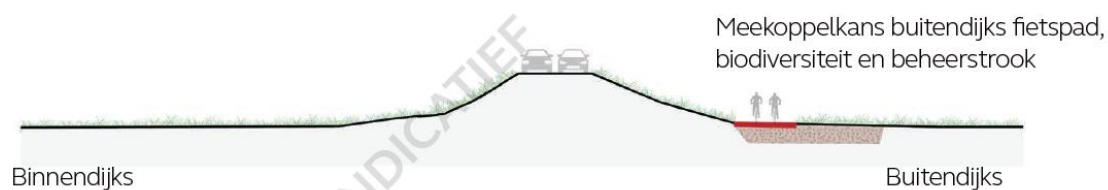
Figuur 5-5: Alternatief in grond, buitendijks; uitgaande van opgave piping en heave (weerstand voorland)
