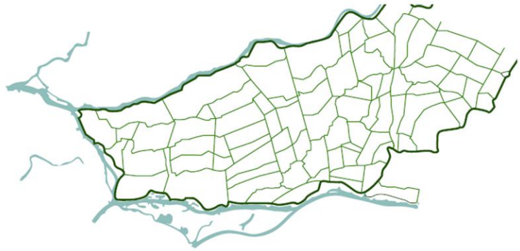
Middeleeuwen: Ontginning veenmoeras, afgraven smalle afwateringsloten, ontstaan van blokstructuur
