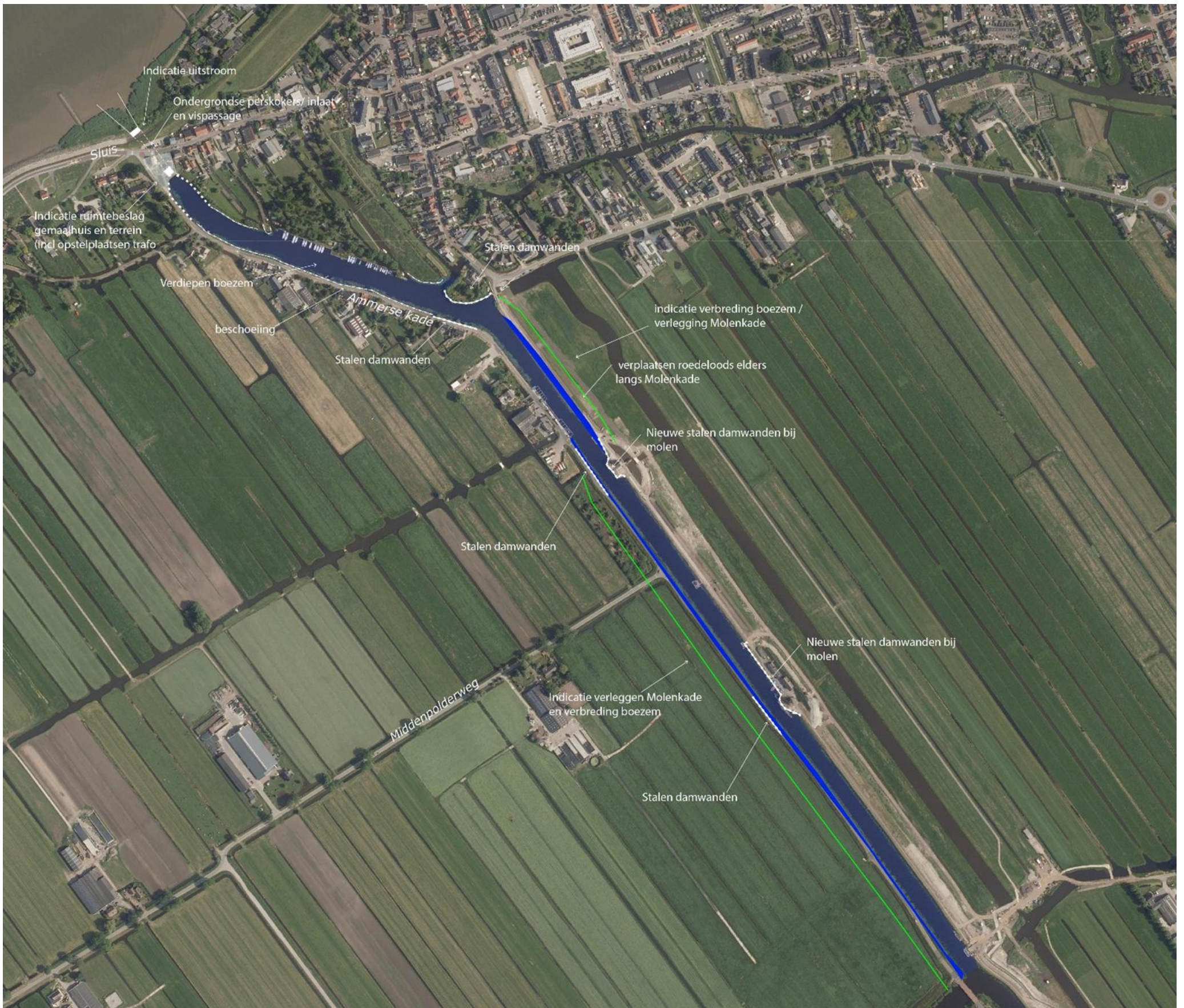
Figuur 67: Indicatie aanpassingen boezem en boezemgemaal bij Groot-Ammer's Sluis 600.
