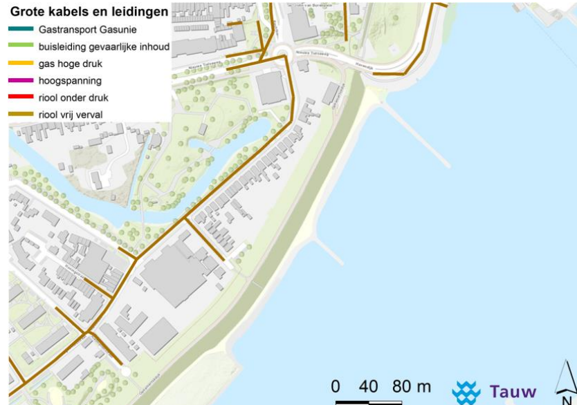
Figuur 10.5 Overzicht kabels en leidingen in deeltraject Ophemertsedijk (Bellevue – Aldi-terrein)
