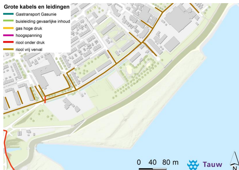
Figuur 10.6 Overzicht kabels en leidingen in deeltraject Ophemertsedijk (Aldi-terrein - Inundatiekanaal)
