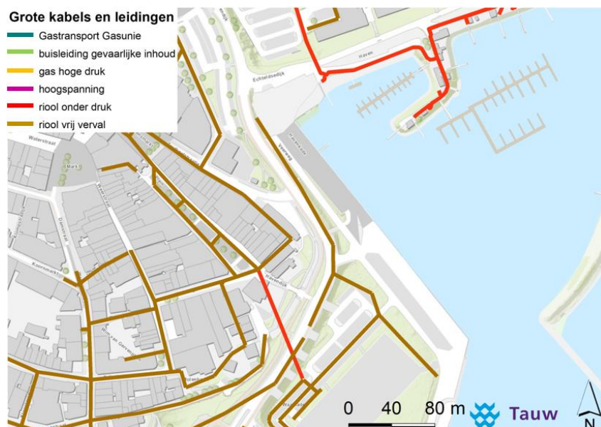
Figuur 10.3 Overzicht kabels en leidingen in deeltraject Stadswallen – Havendijk
