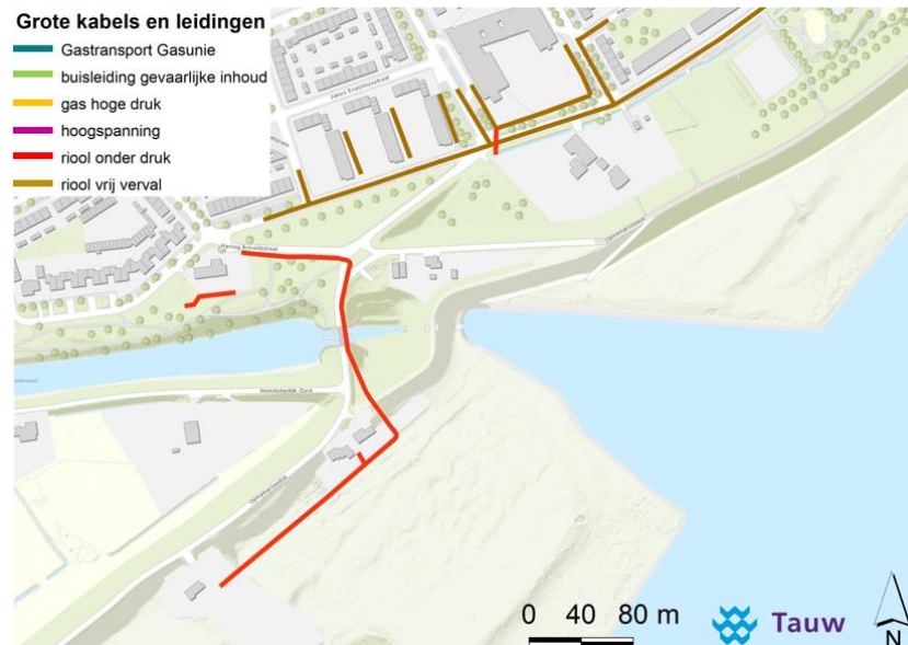
Figuur 10.7 Overzicht kabels en leidingen in deeltraject Inlaatduiker Inundatiekanaal
