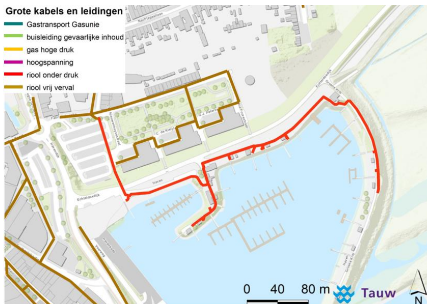
Figuur 10.2 Overzicht kabels en leidingen in deeltraject Haven
