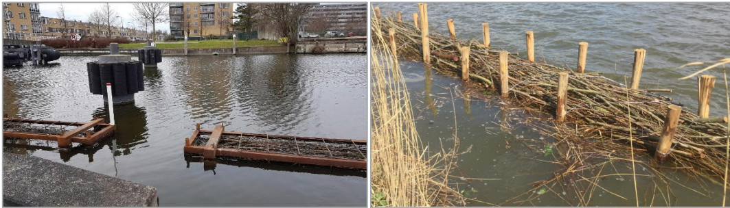
Figuur 4.18 Proefopstellingen vissenbossen, aangelegd door Hoogheemraadschap Delftland.
