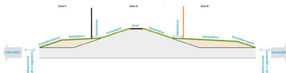
Figuur 3-1: Principe opbouw van de waterkering. De waterkering als waterstaatswerk is begrensd door de ruimte tussen de binnenteen en de buitenteen, plus een beschermingszone van 4 meter aan de binnen- en buitenzijde.
