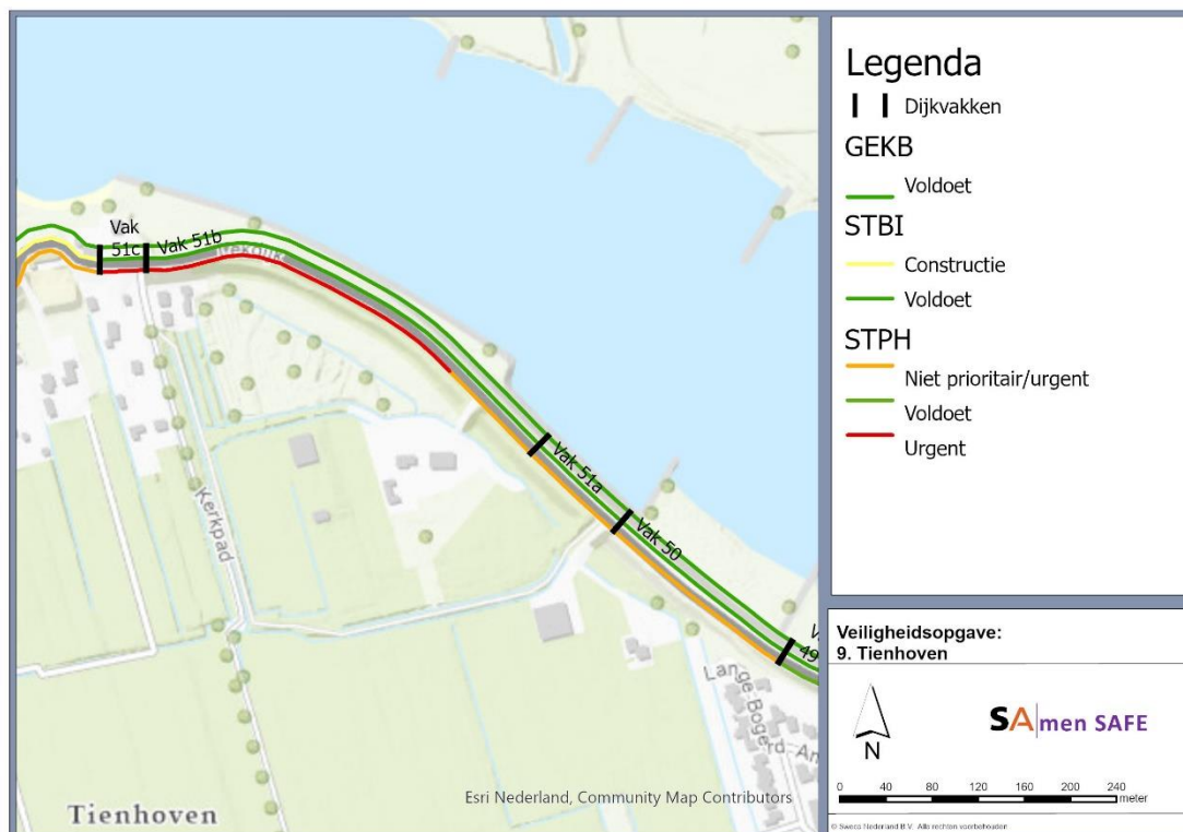
Figuur 12.2 Veiligheidsopgave planuitwerkingsfase dijkzone 9. De rode lijn geeft aan welke delen niet voldoen aan de norm
