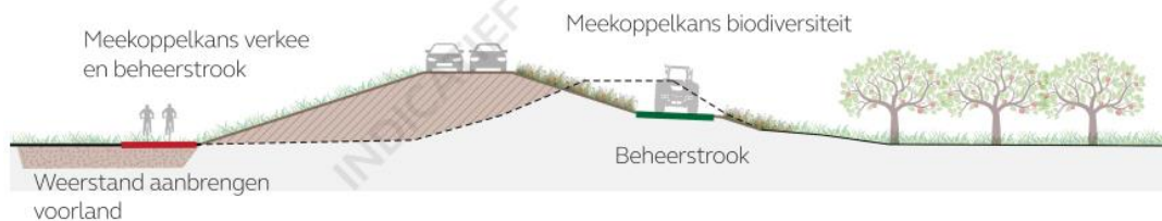
Figuur 14 Alternatief in grond, buitendijks; uitgaande van opgave piping en heave (weerstand voorland), biedt ook oplossing voor macrostabiliteit binnendijks
