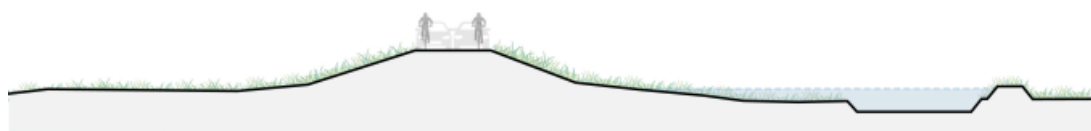
Figuur 19 Alternatief met behoud van functie kwelkade in de legger; uitgaande van opgave piping en heave
