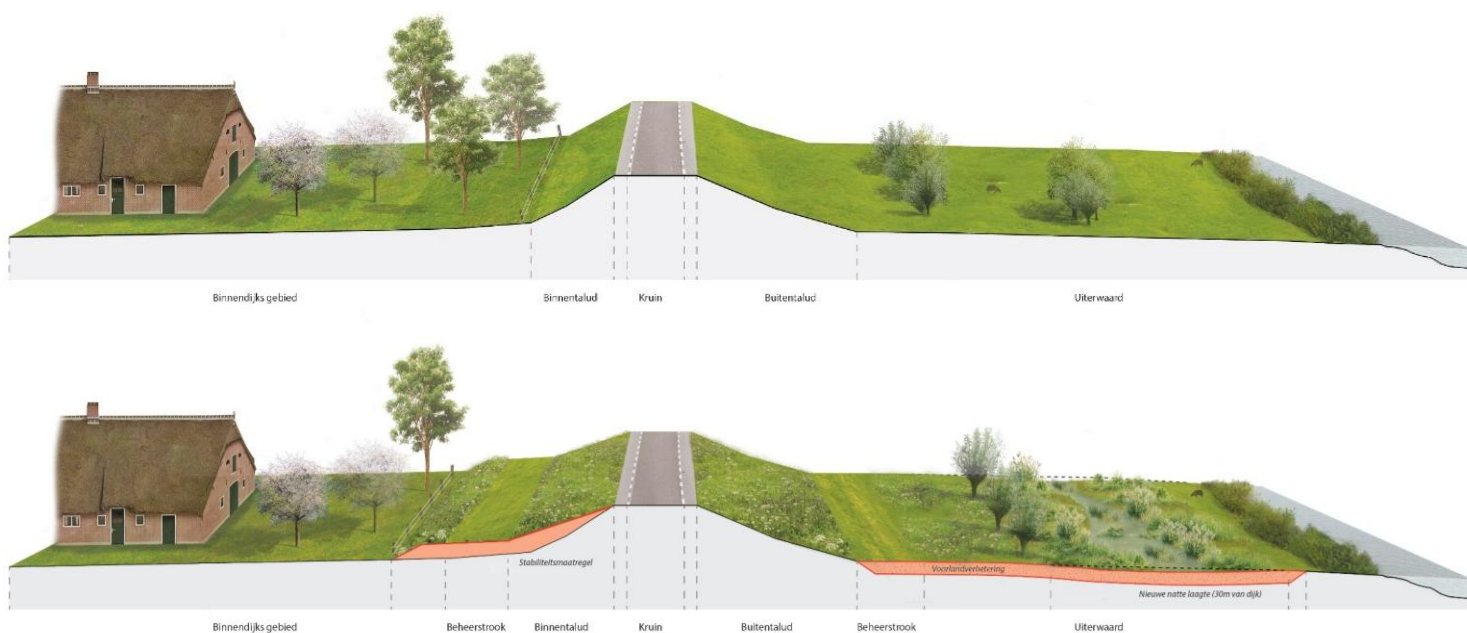
Figuur 0-1 Indicatief principeprofiel van kansrijk alternatief “Natuurlijk versterkt”. Het bovenste profiel toont de huidige situatie. (zie voor een grotere weergave pagina 27)
