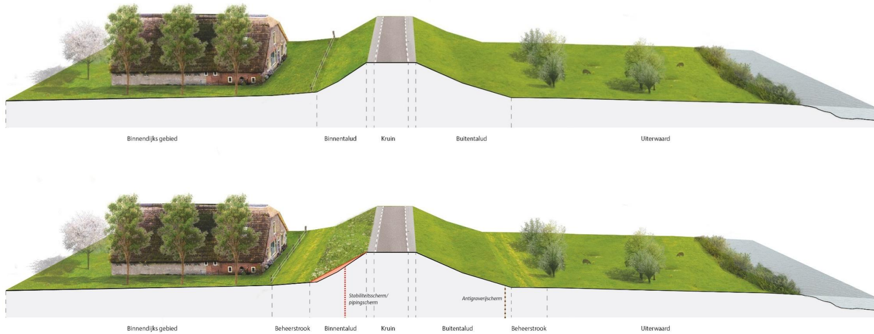
Figuur 5-3 Indicatief principeprofiel van kansrijk alternatief "Vertrouwde dijk". Het bovenste profiel geeft een indicatief beeld van de huidige situatie en het onderste profiel geeft een indicatieve impressie van het alternatief met de versterkingsbouwstenen in rood.
