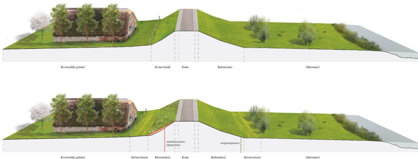
Figuur 0-2 Indicatief principeprofiel van kansrijk alternatief “Vertrouwde dijk”. versterkingsbouwstenen in rood. Het bovenste profiel toont de huidige situatie. (zie voor een grotere weergave pagina 27)
