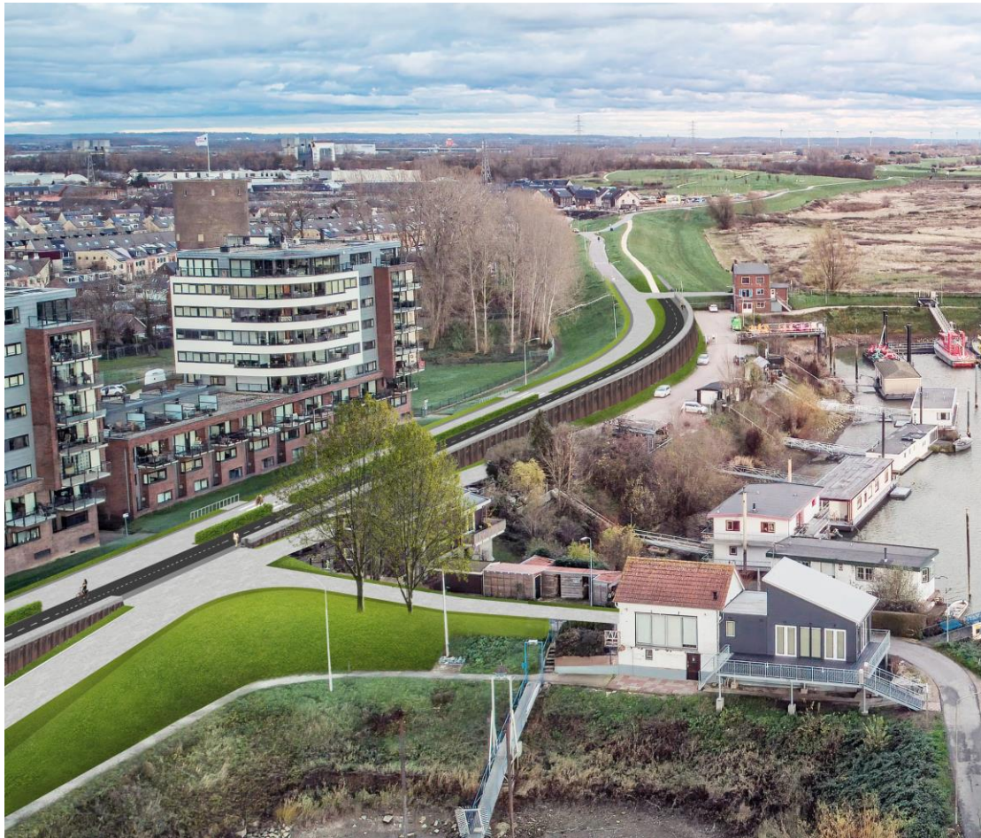
Figuur 4.7 Visualisatie van de oplossing tussen Fluvia Tiel en de Nieuwe Havendijk. De buitenste damwand van deze constructie is zichtbaar. Afhankelijk van de beschikbare financiering volgen in het DO alternatieven voor de aankleding.
