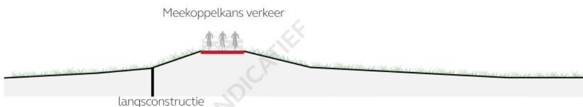
Figuur 5-8: Alternatief met constructies; uitgaande van opgave piping (damwand)
