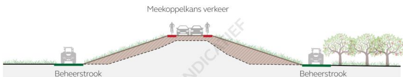
Figuur 5-12: Alternatief vierkant versterkt; uitgaande van opgave macrostabiliteit binnenwaarts
