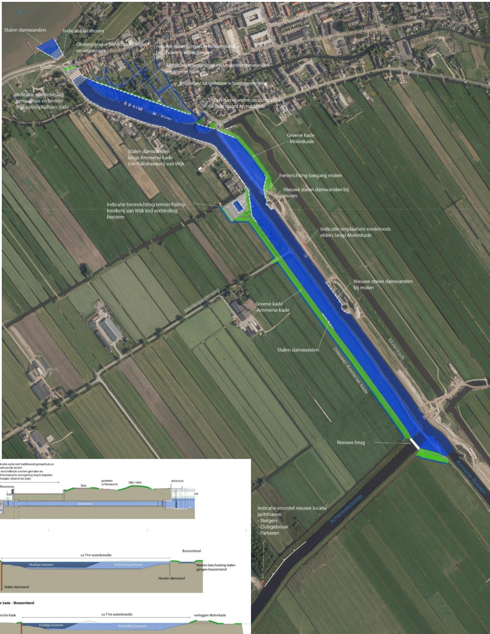
Figuur S4: Kaart met schetsontwerp boezem en gemaal Groot-Ammers Sluis incl. dwarsdoorsnedes.
