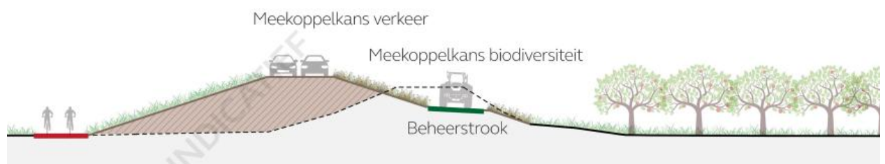
Figuur 5-4: Alternatief in grond; uitgaande van opgave macrostabiliteit buitendijks (kortere hoge berm)
