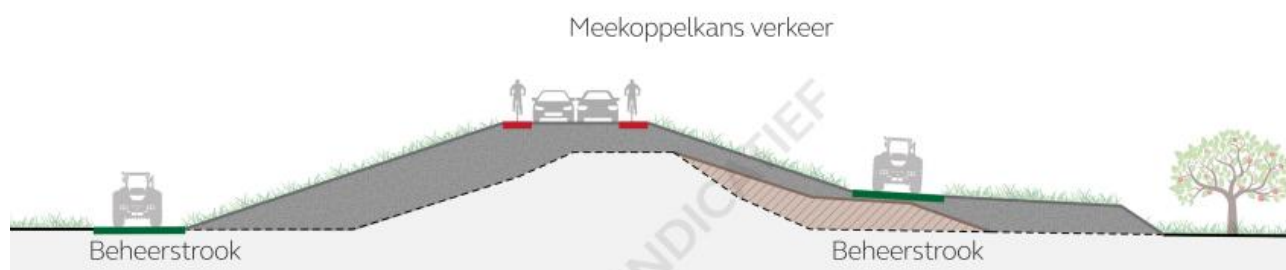
Figuur 5-14: Alternatief klimaatdijk; uitgaande van opgave macrostabiliteit (stabiliteitsberm)
