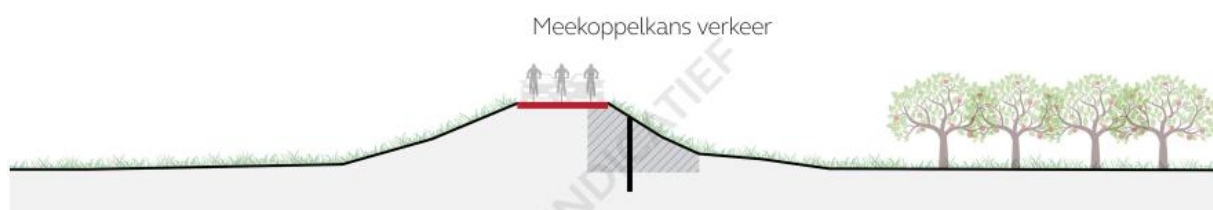
Figuur 5-6: Alternatief met constructies; uitgaande van opgave macrostabiliteit binnendijs (damwand en/of dijkvernageling) biedt door verlenging damwand ook een oplossing voor piping en heave
