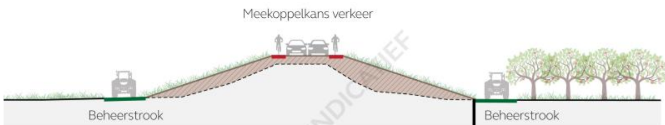
Figuur 5-13: Alternatief vierkant versterkt; uitgaande van opgave macrostabiliteit binnenwaarts en piping
