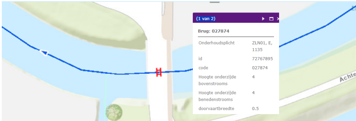
Figuur 2.2a: Het waterstaatswerk brug. De brug onderbreekt de bodem van het water niet.
