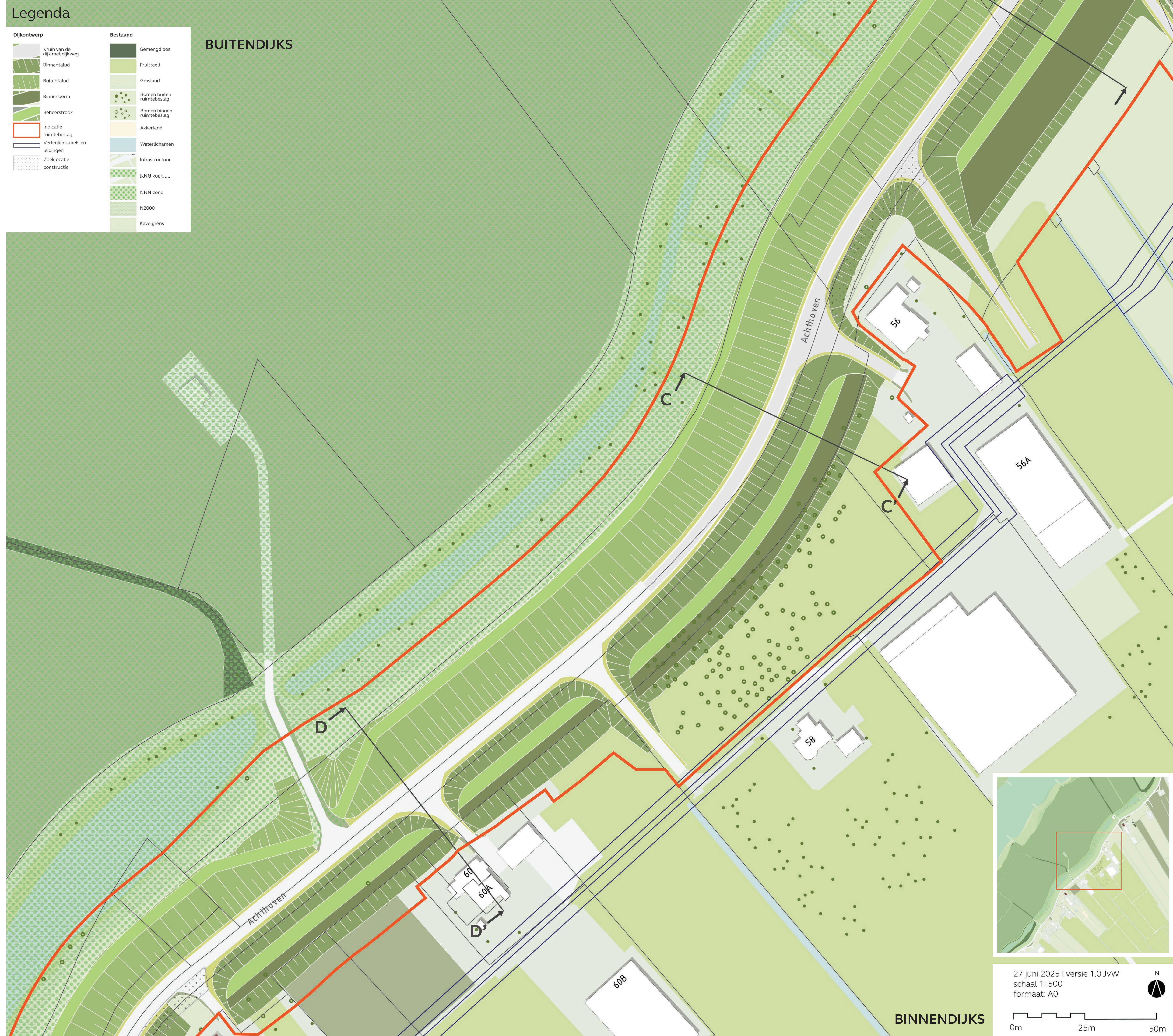
Profiel CC' Buitenwaartse asverschuiving, kruinverhoging en binnenberm
