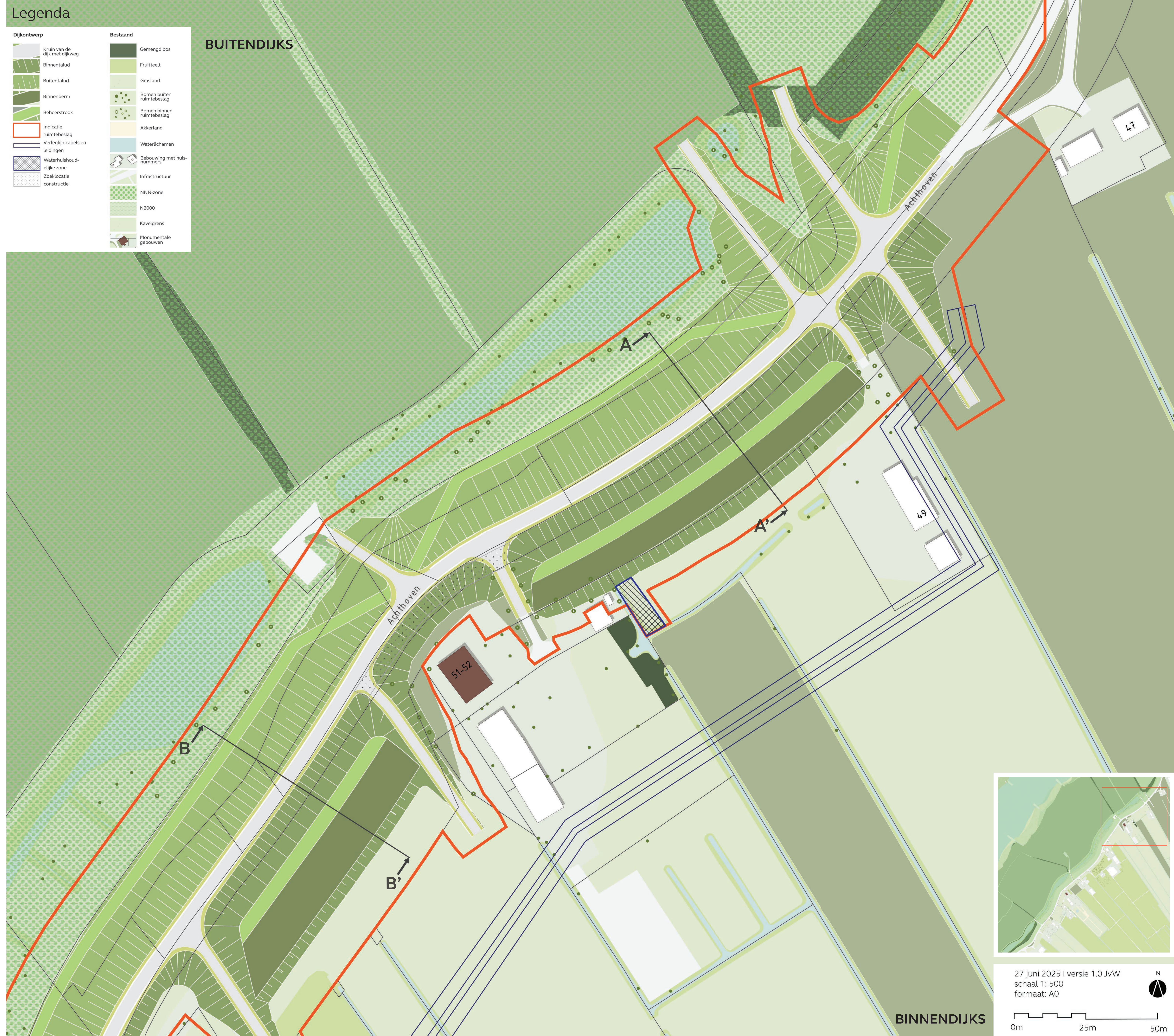
Profiel AA' Buitenwaartse asverschuiving, kruinverhoging en binnenberm
