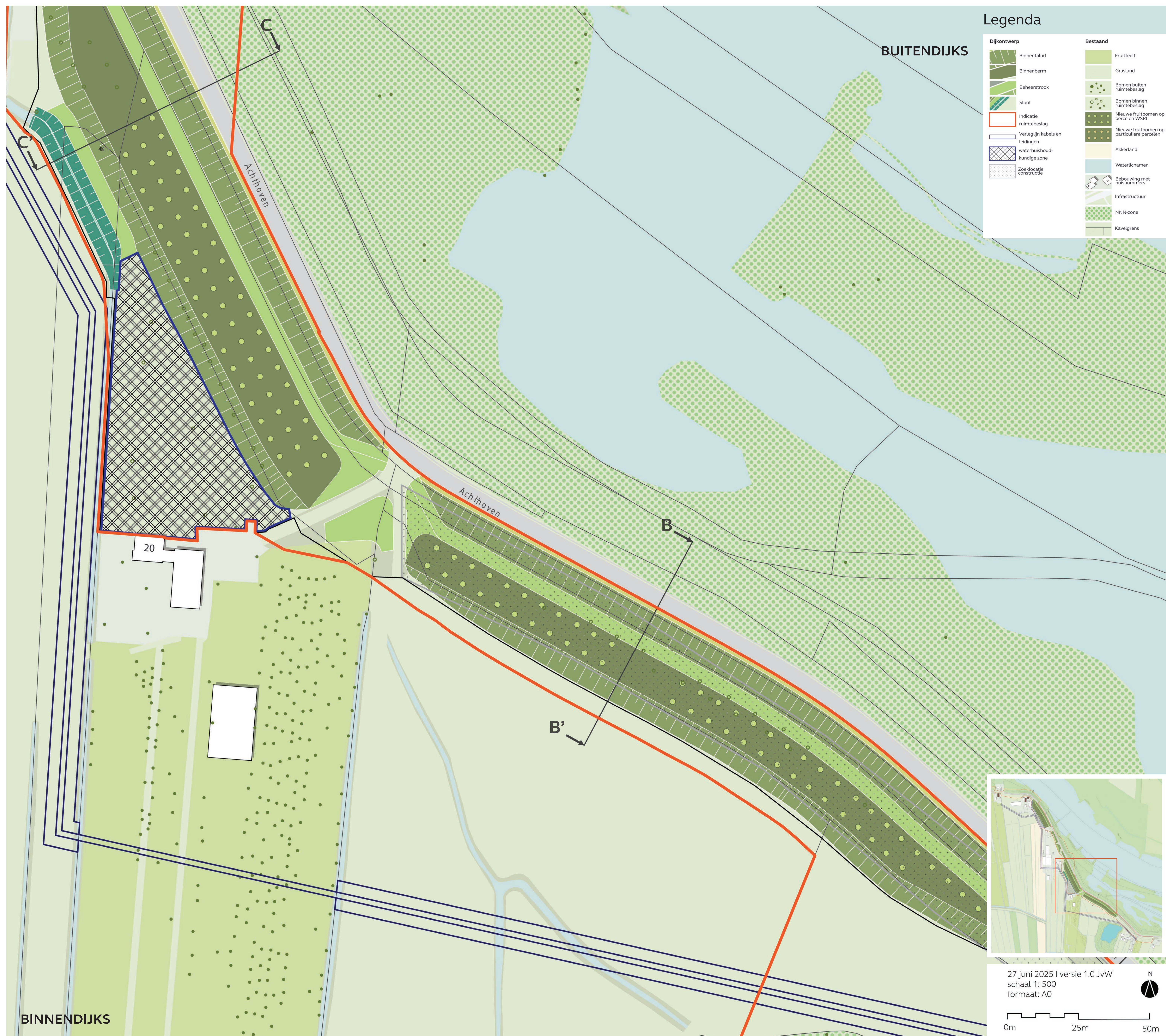
Profiel BB' Verbreding binnenberm
