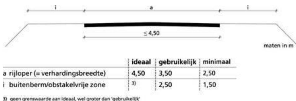
Figuur 3: Breedte rijloper ETW type 2 (Handboek wegontwerp, CROW)
