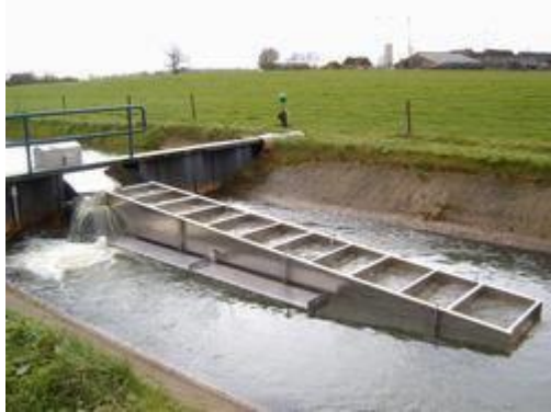
Proefopstelling Meyberg-vispassage WRIJ Bron: Jasper Arntz Tauw
