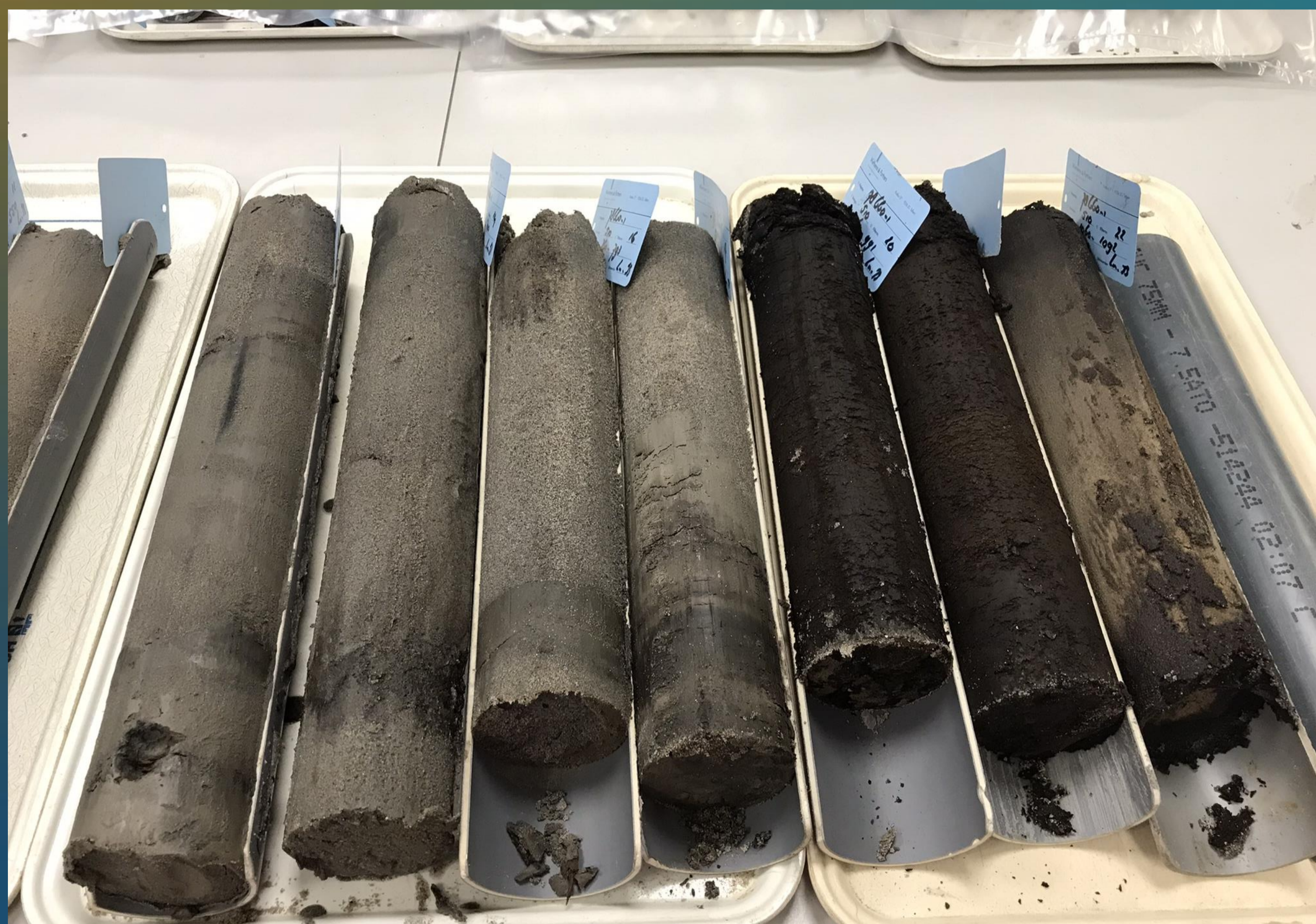
Een uitgelegde boring van de grondopbouw van de dijk
