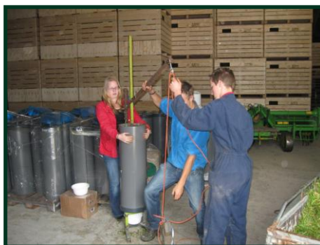
Op de foto links wordt snijmaïs ingekuuld in de pvc-buizen. Studenten van de CAH Dronten wegen een gewicht die de druk op de kuil simuleert.
