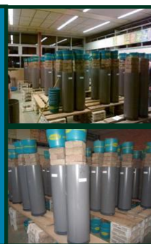
De foto's rechts geven de ingekuilde buizen weer. In dit vooronderzoek zijn 96 buizen ingekuuld. Hier zijn verschillende absorberende producten toegepast op verschillende manieren.
