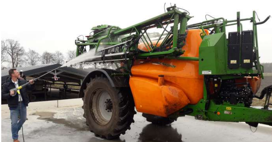
Figuur 14: Wasplaats voor spuitmachines zonder restlozing
