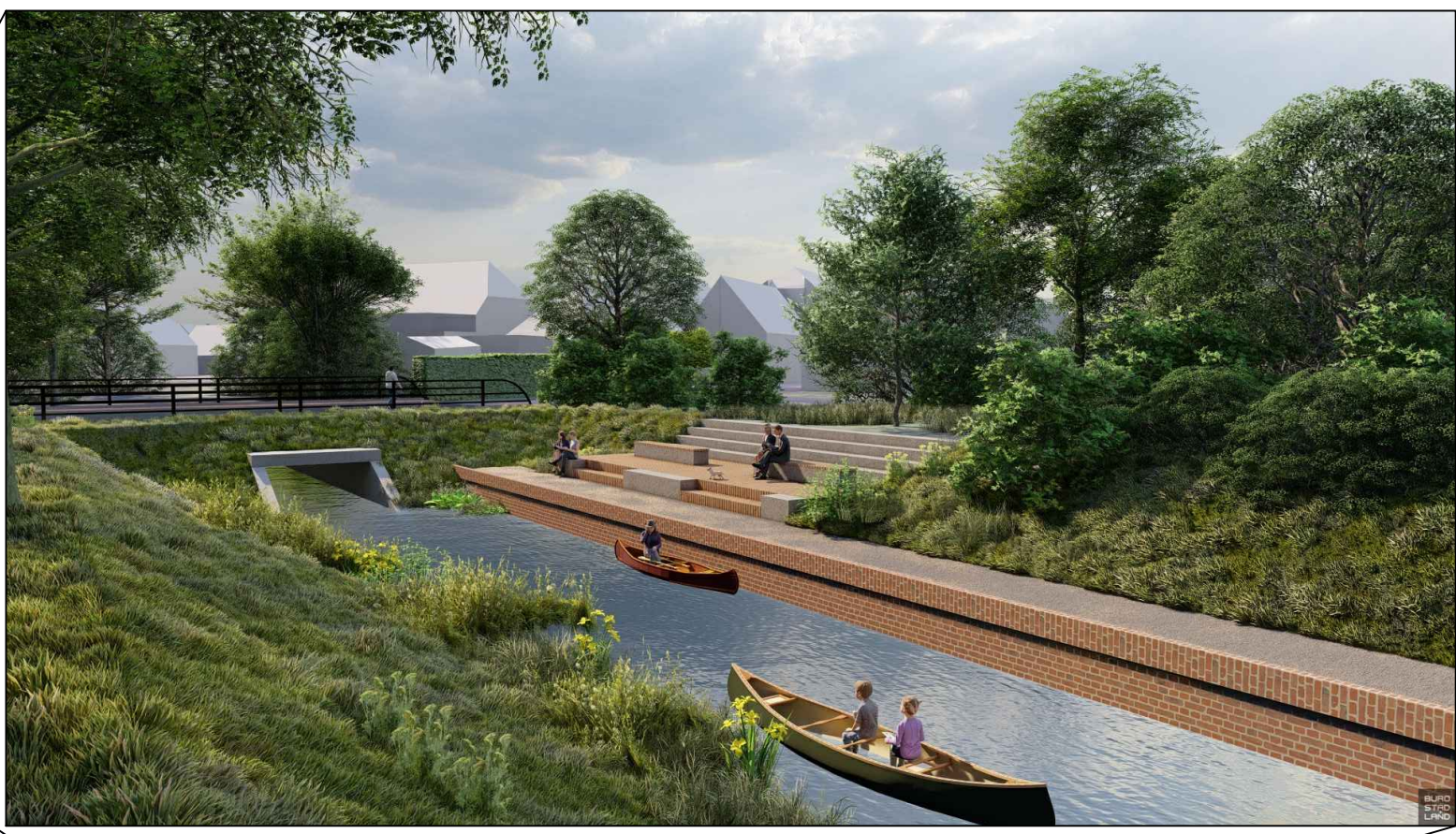
Zicht op De Lindt, met aan één zijde een natuurvriendelijke oever en aan de andere zijde een kademuur
