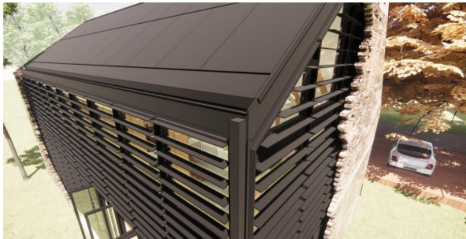
Detail van de goot en HWA met zonwering
