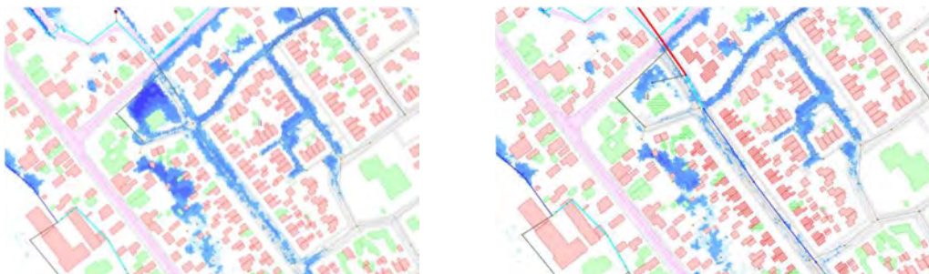
Figuur 3 Omvang wateroverlast Spoorlaan en Nieuwstraat voor en na maatregelen
