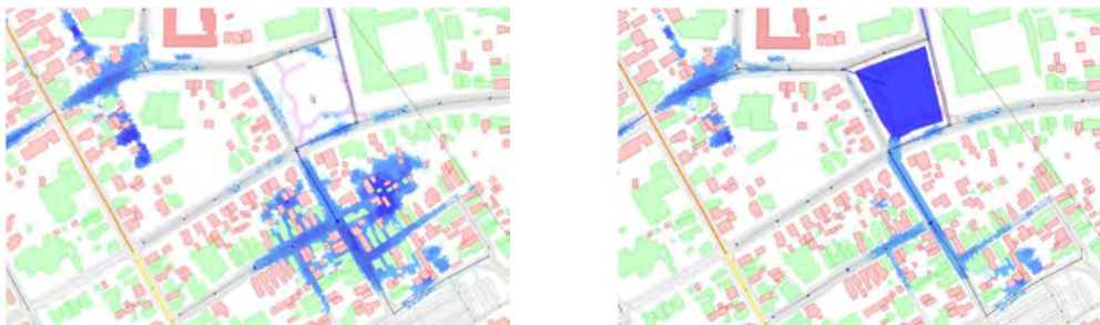
Figuur 6 Omvang wateroverlast Tjerk Hiddestraat en Sickengastraat voor en na maatregelen
