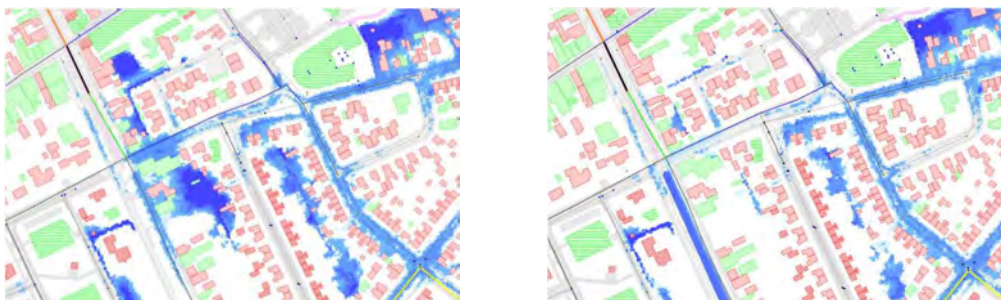
Figuur 1 Omvang wateroverlast Reitsmastraat voor en na maatregelen
