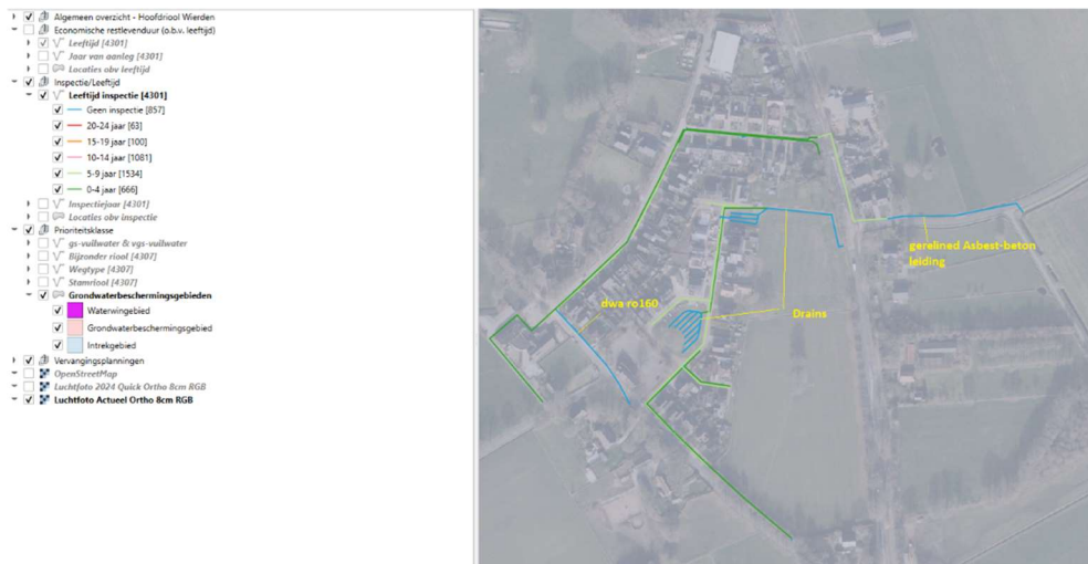
Figuur 10 Vrijvervalriolering rioolinspectie in grondwaterbeschermingsgebied Hoge Hexel
