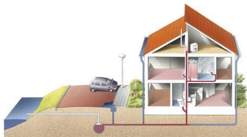
Voor afkoppelen: regenwater en vuilwater wordt via één leiding afgevoerd
