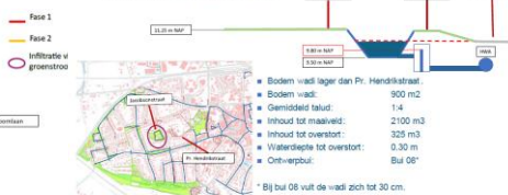
Figuur 28 Doorsnede wadi Jacobsonstraat
