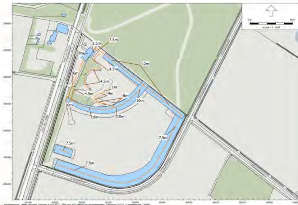
figuur 9: ligging van stelsel van aaneengesloten geluidsafschermingen en overkappingen van de schietposten (BBT-maatregelen) in de beoogde situatie
