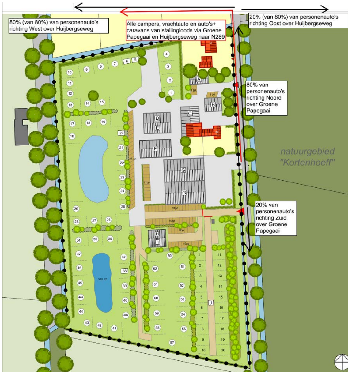
Figuur 2.2: Overzicht locatie voertuigbewegingen indirecte hinder
