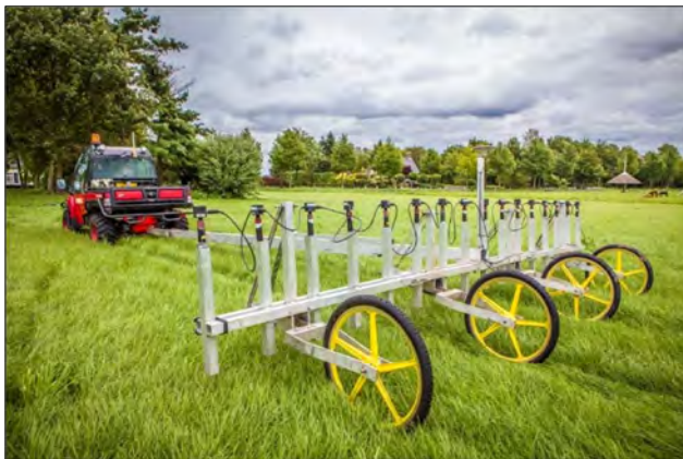
Figuur 3. Passieve non realtime oppervlakedetectie met het Vallon Multisondesysteem VXV16 en een staafdiagram waarop het maximale detectiebereik (m 2 - maaiveld) per kaliber is weergegeven.
