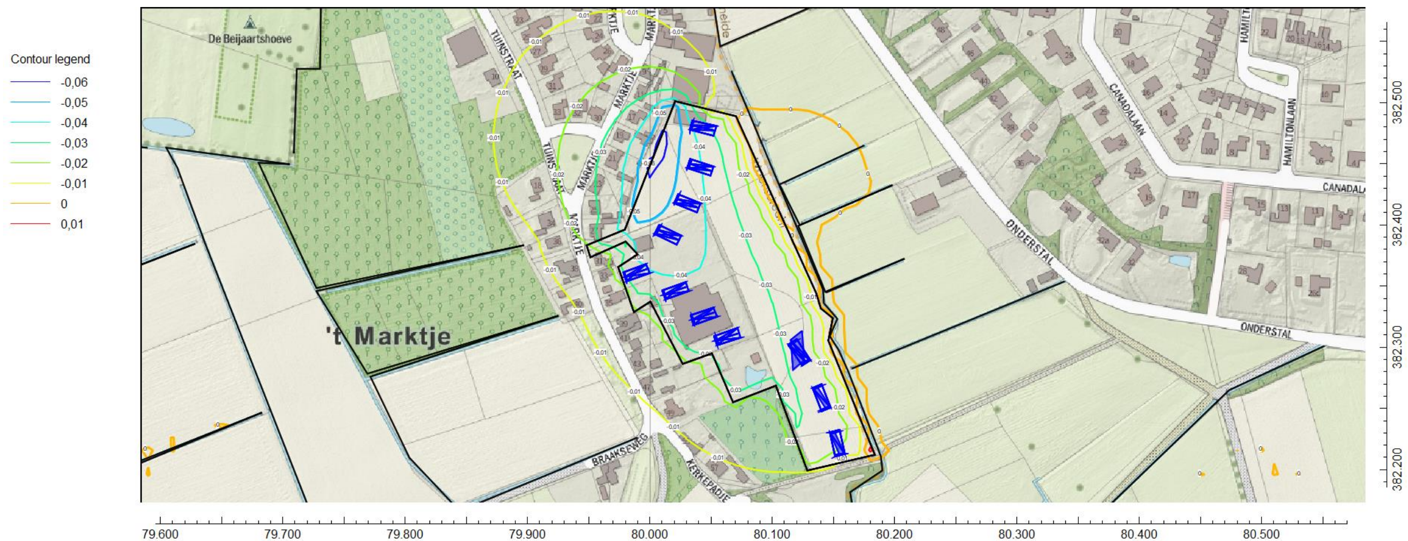
Figuur 4.2 Verhoging grondwaterstand [m] door ophoging. Een verhoging wordt aangegeven met een negatief getal (negatieve verlaging)
