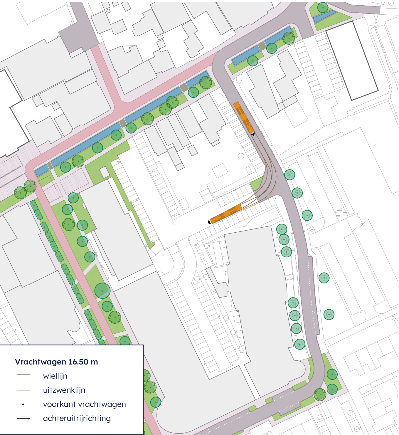
Bij ontwerpvoertuig trekker met oplegger (zonder meesturende achteras) moeten er aanpassingen worden gedaan aan de hoeveelheid parkeervakken en aan de huidige bochtstraal als de vrachtwagen vanaf de Pastoor Mercuriusstraat richting de laad- en losplek moet rijden.
