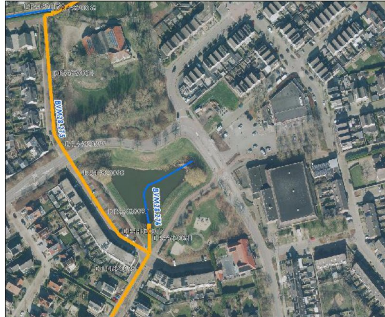
De vijvers in Beinum staan onderling met elkaar in verbinding door middel van een ondergronds watersysteem (duikers), dit zijn de gele lijnen op de afbeelding.
