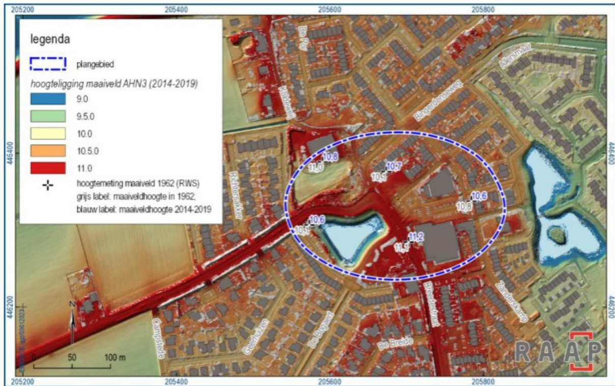
Figuur 5. Hoogtemetingen van 1962 (RWS; grijze labels) vergeleken met die op het AHN3 (blauwe labels).
