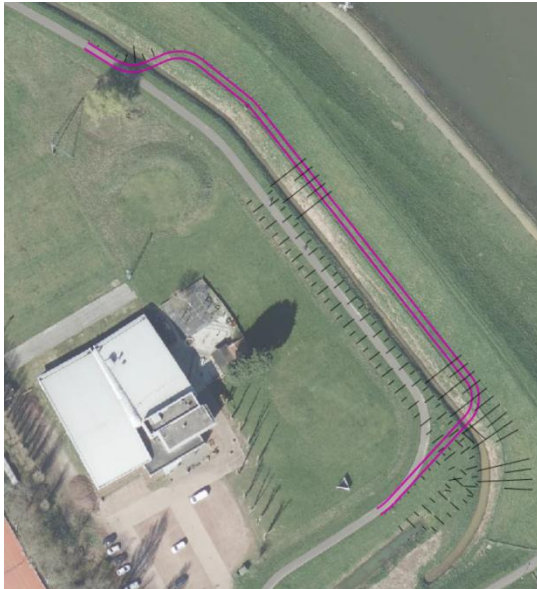
Figuur 9.10 Oude Maas Noord – verplaatsing van het pad bij verlegging binnenwaarts.
