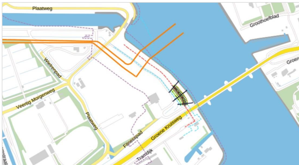
Figuur 8.3 Kabels en leidingen ter hoogte van Oude Maas Noord (oranje is buis gevaarlijke inhoud, NAM).
