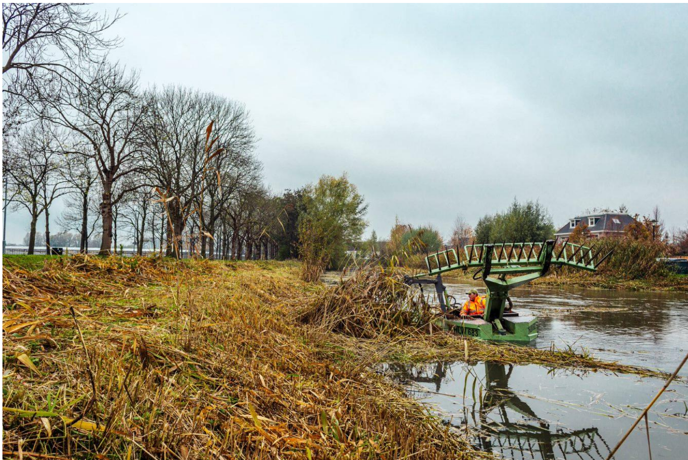
Figuur 3. Maaien watergang met behulp van maaiboot
