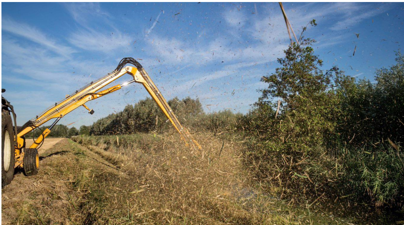
Figuur 4. Klepelmaaier met blaassysteem
