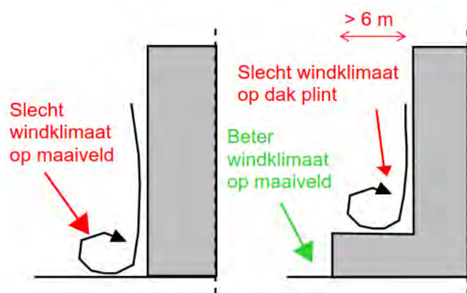
Figuur 5.4: Schematische windstromingen rondom vrijstaande hoogbouw
