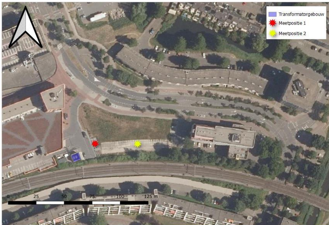
Afbeelding 4.1 Meetposities ter bepaling van het referentieniveau
