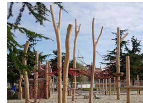
13 Custom robinia palen, inclusief klimelementen, valhoogte <1m Extra robinia palen in diverse hoogtes toevoegen (zie tekening) om één geheel van het speleiland te maken. Enkele palen uitvoeren met klimelementen of vork-vorm
