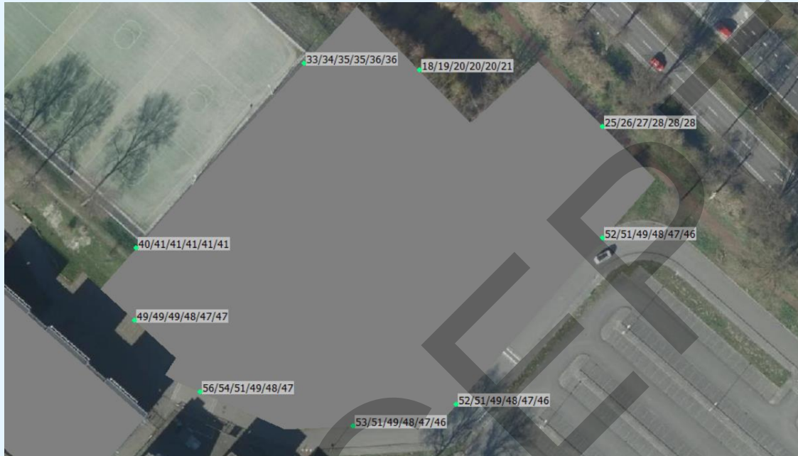
figuur 9: geluidsbelasting wegverkeer (inclusief 5 dB aftrek) ten gevolge van de 30 km/u wegen
