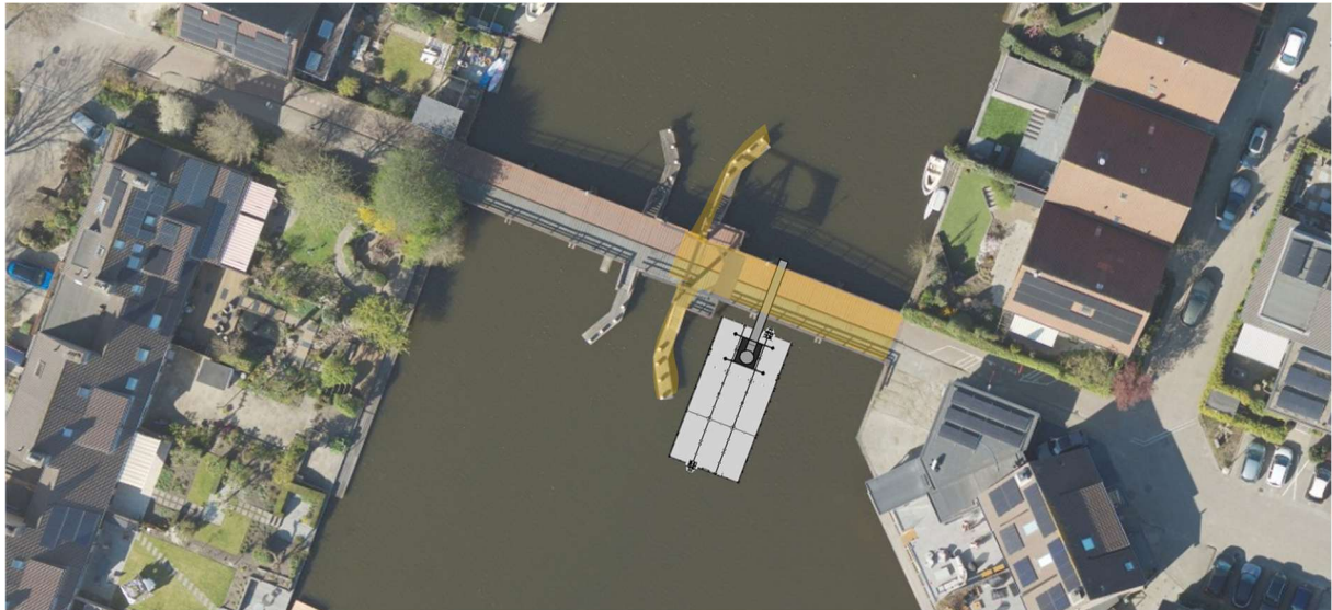
Figuur 12: Aanbrengen van de nieuwe stalen langsliggers (Fase 5.2)
