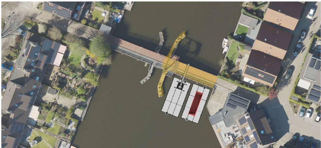
Figuur 8: Deelvervangning van de meerpalen (Fase 3.2)
