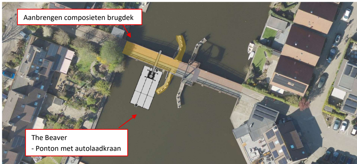
Figuur 13: Aanbrengen van het nieuwe composieten brugdek (Fase 6.1)
