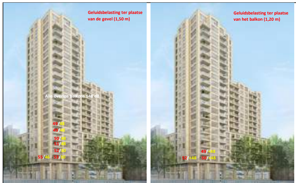
Figuur 11 Geluidsbelasting vanwege de Europaweg [rood dB]/Luxemburglaan [geel dB] achter een balkonscherm van 1,20 meter hoog
