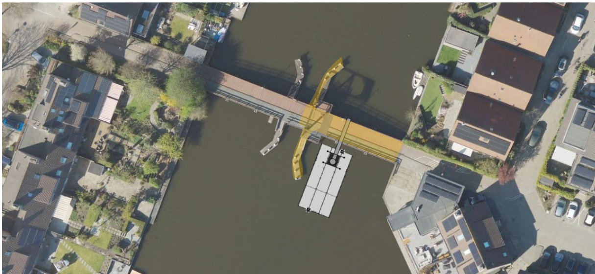
Figuur 9: Aanbrengen van de nieuwe stalen kespen (Fase 4.2)
