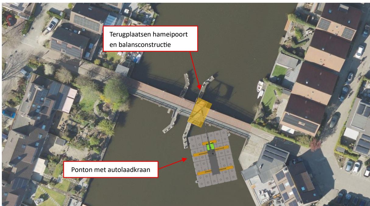
Figuur 16: Montage van de hameipoort en balansconstructie
