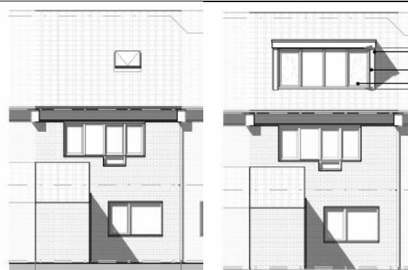
Voorgevel bestaand en nieuw
