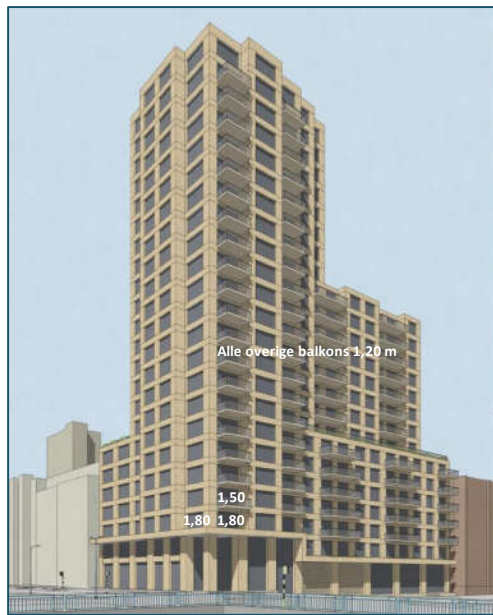
Figuur 7 Hoogte balustrade om te voldoen aan de eis van een luwe buitenruimte
