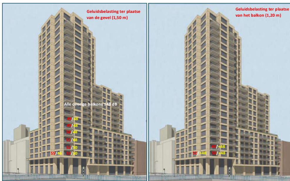
Figuur 11 Geluidsbelasting vanwege de Europaweg [rood dB]/Luxemburglaan [geel dB] achter een balkonscherm van 1,20 meter hoog
