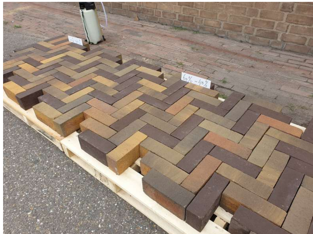
Zoetermeerse-mix, dikmaat keperverband, mix van 60% Aurora, 40% Inverno, type DF85: 206 x 67 x 85 mm, Kwaliteit klasse A4-12G,
