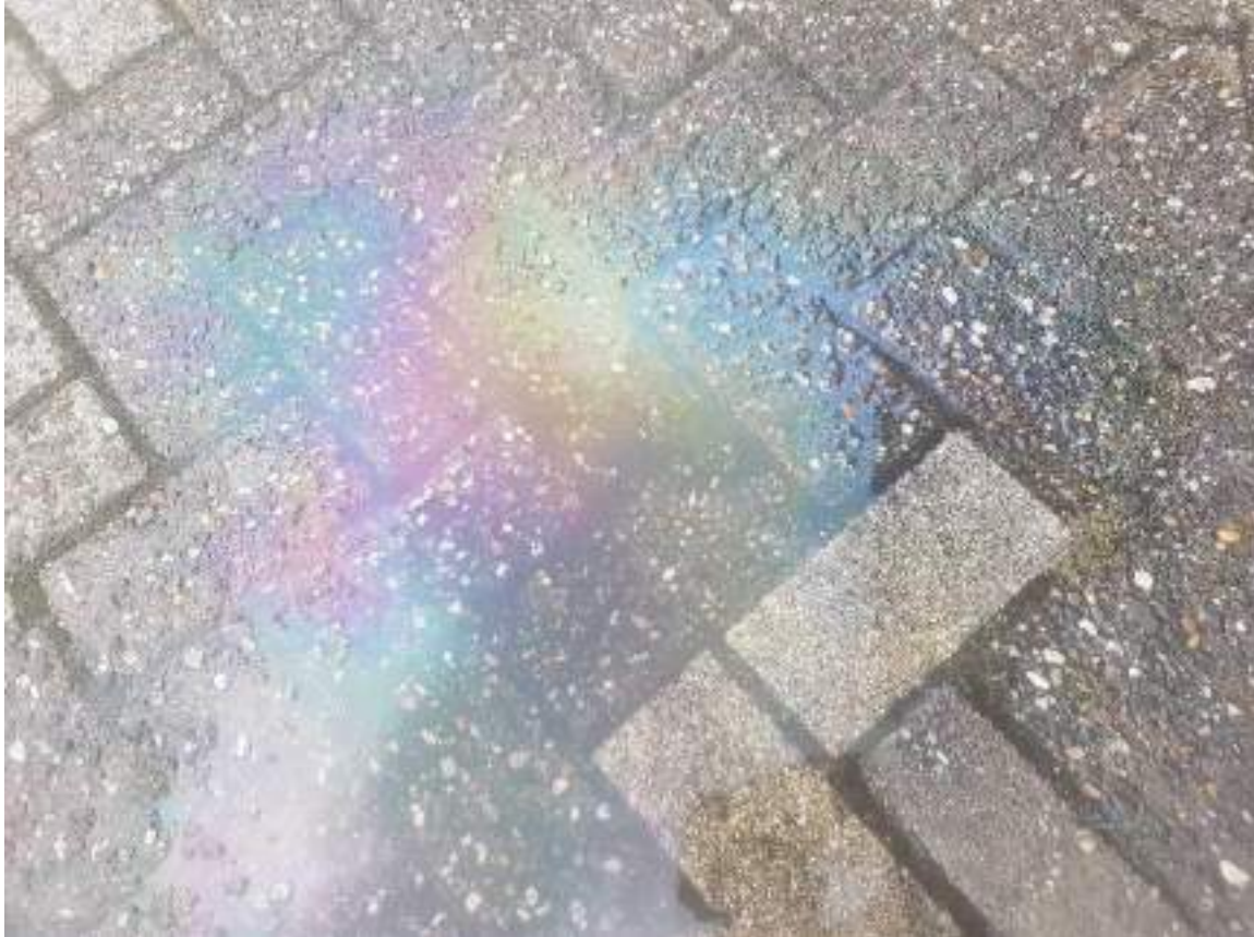
Foto 20. Oliefilm op water nabij dieselpomp en wasloods
