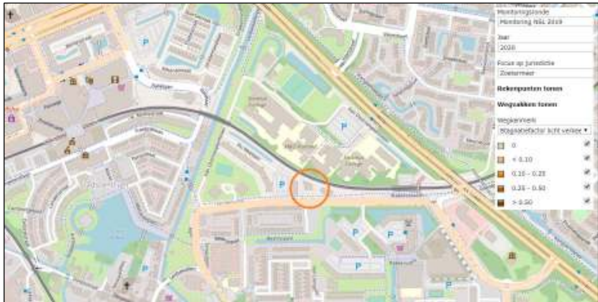
Figuur 6. Stagnatiefactor verkeer rondom de projectlocatie
