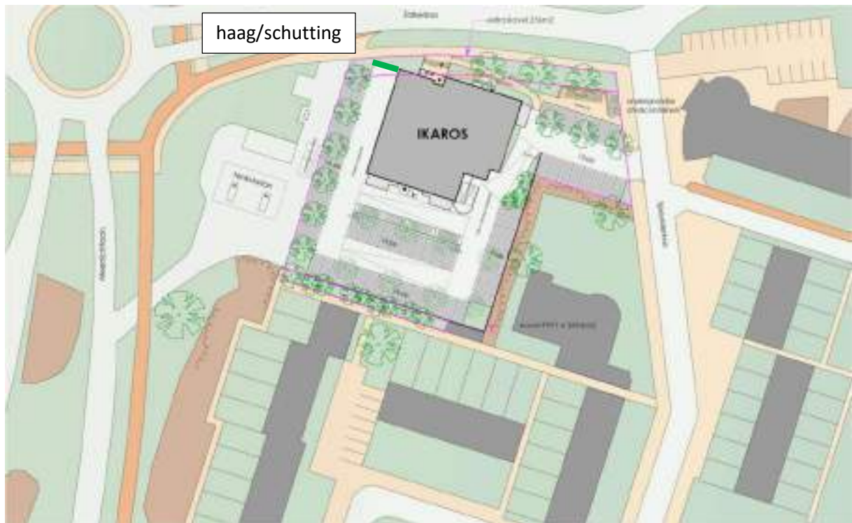
Figuur 3.4.4: Aanbrengen haag/schutting aan noordwestgevel
