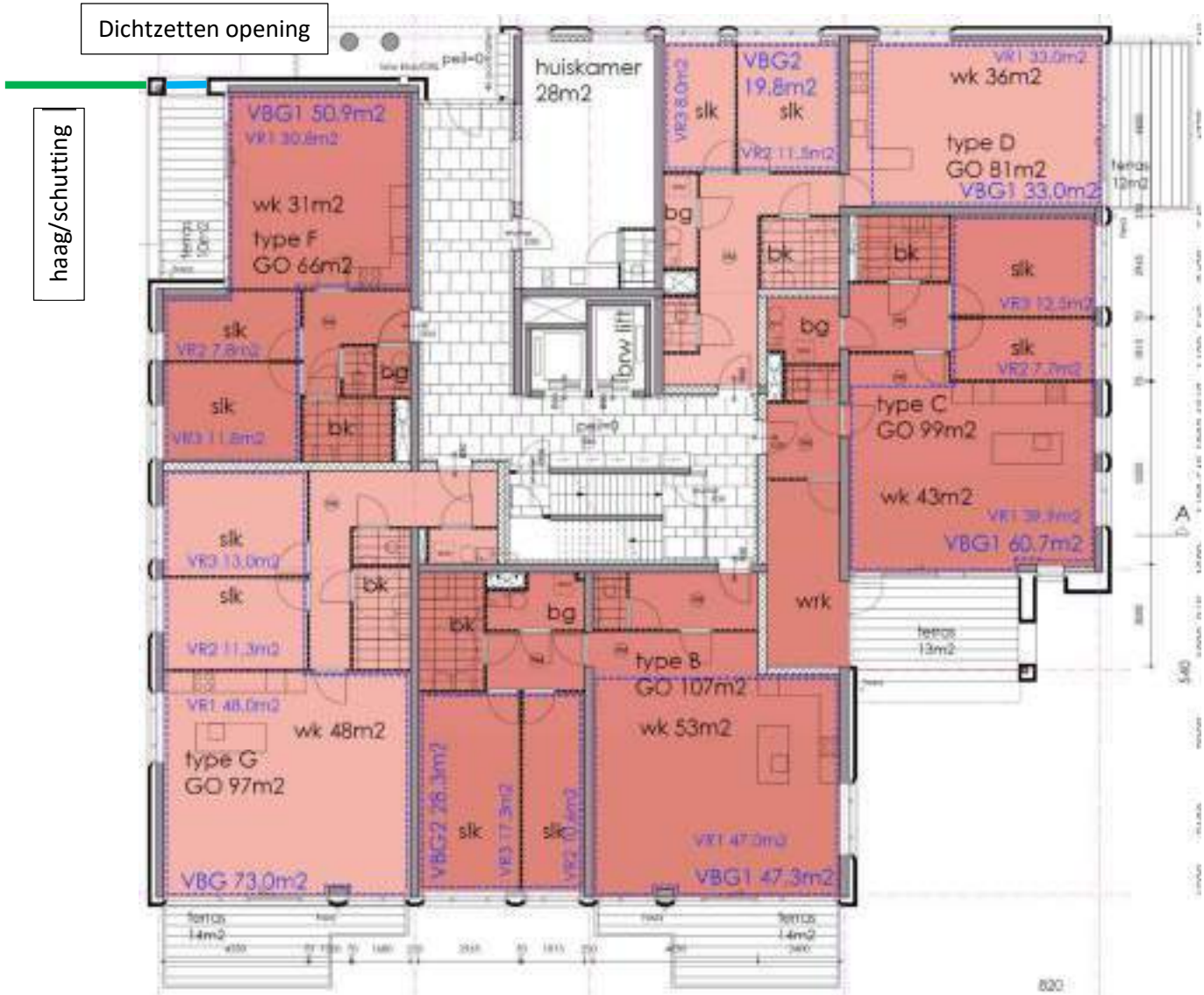
Figuur 3.4.5: Aanbrengen haag/schutting en dichtzetten gevelopening loggia
