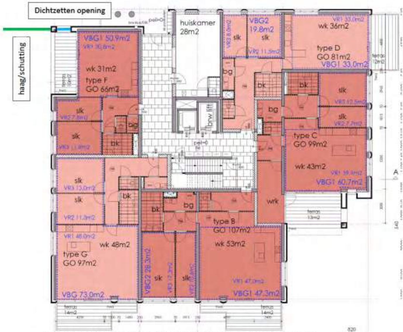
Figuur 3.4.5: Aanbrengen haag/schutting en dichtzetten gevelopening loggia
