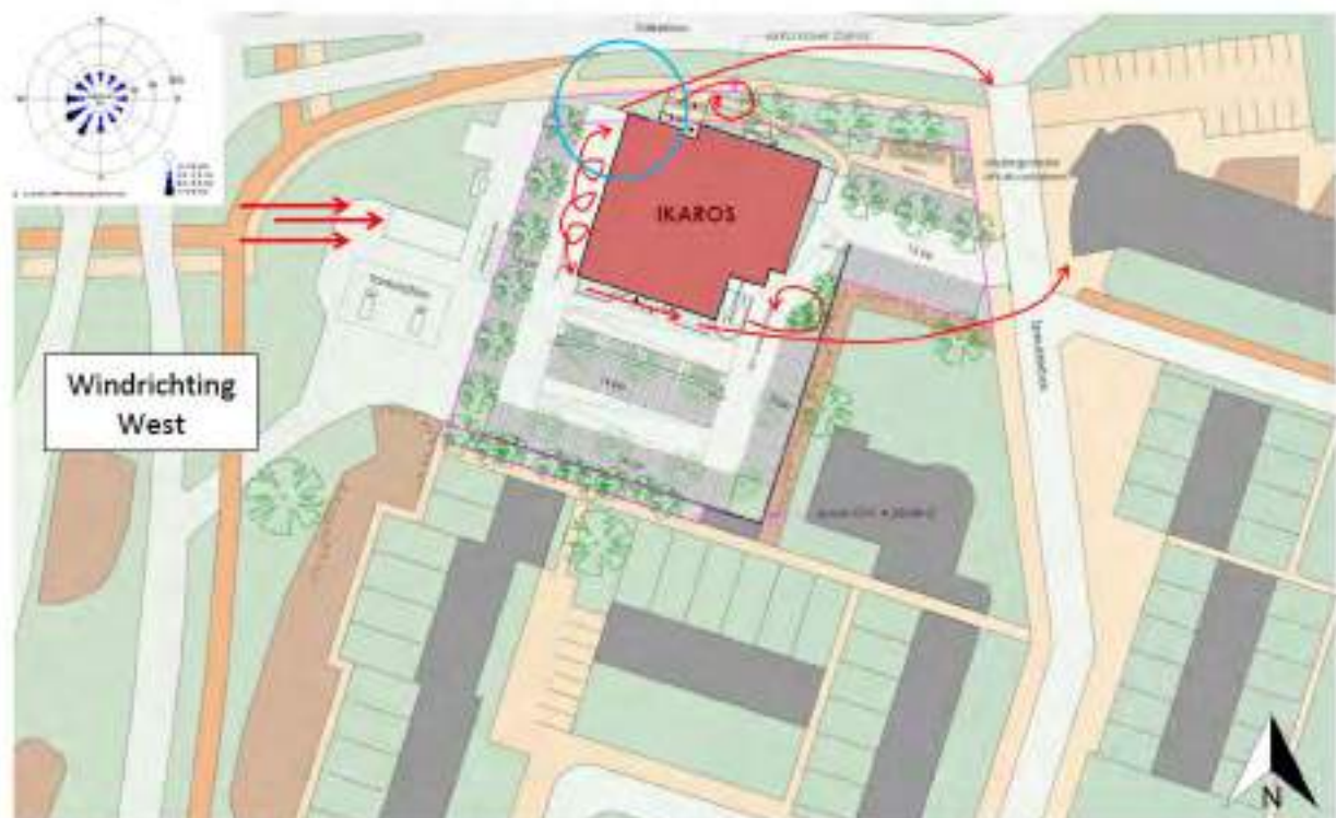
Figuur 3.4.3: Luchtstromingen rondom bouwplan bij de windrichting West
